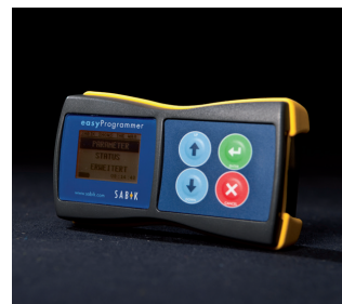
Programador fácil de Sabik Programador bidireccional inalámbrico compacto y fácil de usar.
