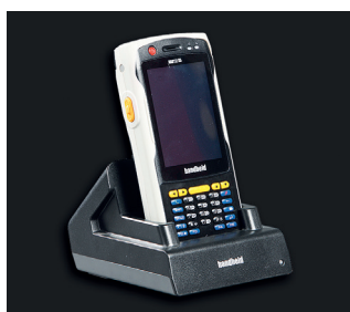
PDA programador Comunicación inalámbrica bidireccional usando un PDA basado en Windows con puerto infrarrojo. Permite configurar el código de destellos, el alcance y el nivel de activación de la fotocelda. El programador también permite recuperar el registro de eventos.
